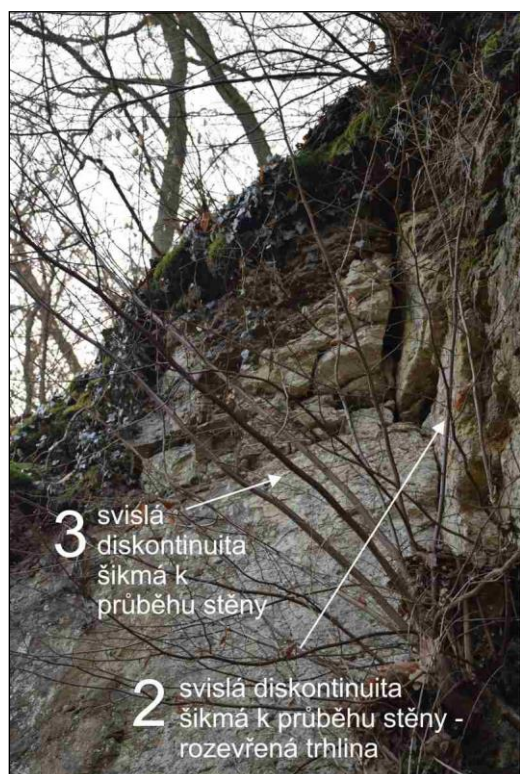
Foto 5 Ukázka interakce systémů diskontinuit 2 a 3 ve stěně vytvářející klínovité vhloubení. Otevřené trhliny na systémech diskontinuit 2 oddělují ve stěně nestabilní části. Na fotografii vpravo je dobře patrný nahnutý nestabilní strom v horní hraně stěny.
